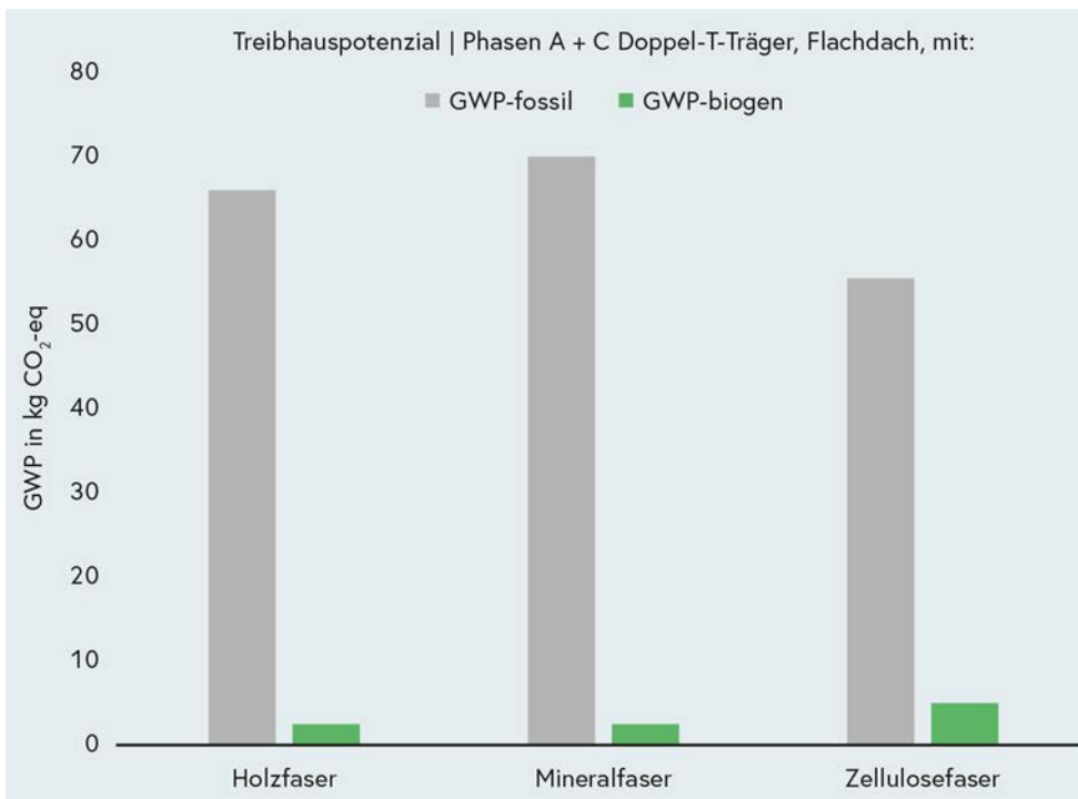
Abbildung 23: Treibhauspotenzial in kg CO 2 -eq der Phasen A und C für Doppel-T-Träger im Flachdach, mit drei Varianten (Holz-, Mineral- und Zellulosefaser) im Vergleich; Quelle: IBO
