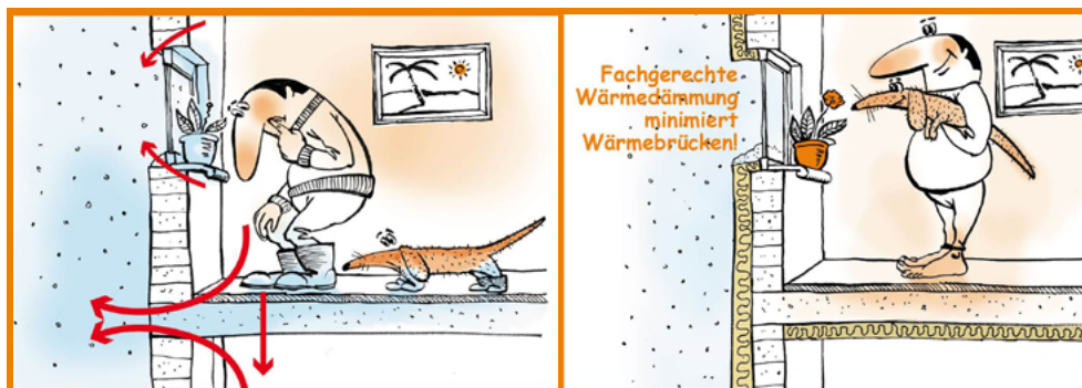
Grafik 10: Wärmebrücke beim Anschluß Kellerdecke an Außenwand
